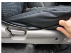
5、付属のヘラを使ってプラスチックの部分にカバーと紐を入れ込みます。
