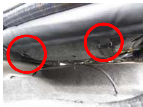
7、赤丸部の部分に6で後ろに回したバンドを通し、マジックテープで固定します。
