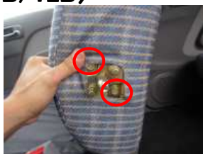
2、アームレスト本体を取り外した後、丸部のボルトを緩め、土台を取り外します。(ボルトサイズ10mm)
