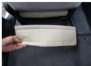
6、画像のパーツを使用し、3で引き出したカバーと座面下のカバーを固定します。
