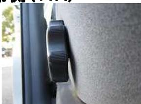
2、ダイヤル型のシートリフターを取り外します。ダイヤルの側面より軸の部分についているピン(リング式)を確認します。
