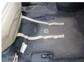
12、カバー前方のバンドをシート下を通して後ろに回し固定します。
