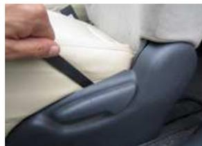
4、付属のヘラを使ってプラスチックの部分にカバーを入れ込みます。
