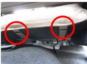
13、赤丸部の部分に9で後ろに回したバンドを通し、マジックテープで固定します。
