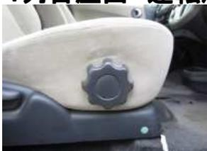
1、まず、シートリフターのダイヤルを取り外します。(シートリフター有り車のみ作業です)
