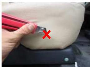
16、ダイヤルの台座の軸を通す穴を、カッターで開けます。
