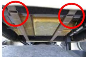
7、赤丸部の部分に8で後ろに回したバンドを通し、マジックテープで固定します。
