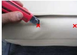
11、9で外したネジを通す穴を、カッター等で切れ込みを入れ開けます。
