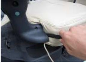
5、付属のヘラを使ってプラスチックの部分にカバーを入れ込みます。
