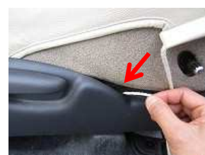
12、カバー側面の紐は画像の矢印の箇所よりシート下に入れ込んで下さい。
