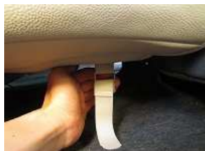
13、12で後ろに回したバンドを赤丸部の金具を通してマジックテープで固定します。
