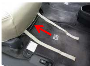
14、カバー前方のバンドをシート下を通して後ろに回します。 ※シート下を通す際は、シートの可動の妨げにならない箇所を通して下さい。
