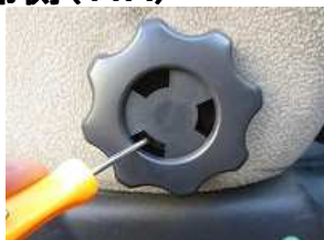
2、ダイヤルの穴より中を覗き、Cリング式のピンを取り外します。
