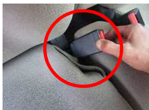
6、シートベルトのバックルをシートのバンドより取り出します。
