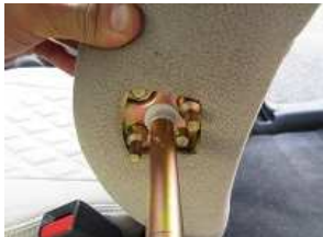
3、台座のボルトを取り外します。 (ボルトサイズ 10mm)
