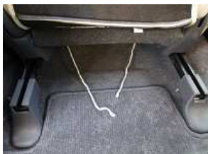
14、シート下に入れ込んだ紐を後ろへ回します。 ※シートの可動の妨げにならない箇所を通して下さい。
