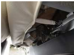
10、9で取り付けしたS字フックはシート下の金属部に引っ掛け固定します。
