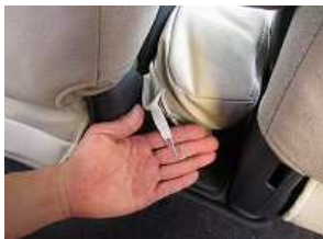
11、シートベルトバックル側のバンドにもS字フックを取り付け、シート下で固定します。
