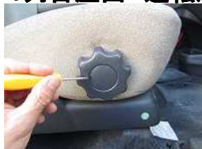
1、シートリフターの中心部のカバーをマイナスドライバー等で取り外します。 (シートリフター有り車のみ作業です)
