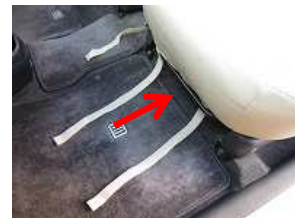
12、カバー前方のバンドをシート下を通して後ろに回します。 ※シート下を通す際は、シートの可動の妨げにならない箇所を通して下さい。
