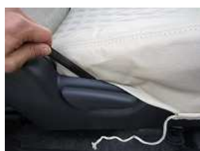
11、付属のヘラを使ってプラスチックの部分にカバーを入れ込みます。
