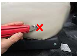
16、ダイヤルの台座の軸を通す切れ込みを、カッターで開けます。
