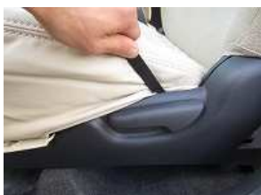
6、ヘラを使ってプラスチックの部分にカバーを入れ込みます。
