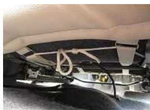
17、後ろへ回した紐をシート下で結び固定します。
