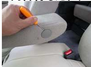
1、アームレストと取り外します。側面のカバーをマイナスドライバーで取り外します。
