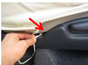
7、カバー側面の紐は画像の矢印の箇所よりシート下に入れ込んで下さい。
