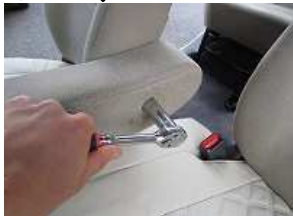
2、ボックスレンチを使用し、中のボルトを外し、アームレストを取り外します。 (ボルトサイズ 17mm)
