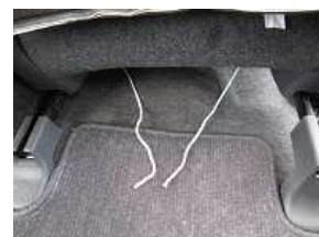
16、シート下に入れ込んだ紐を後ろへ回します。 ※シートの可動の妨げにならない箇所を通して下さい。
