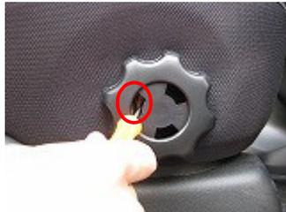
2 本体の隙間から固定しているピンを外し、本体を取外します。
