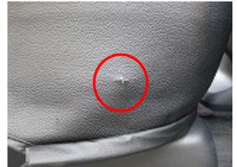
4 カバーを被せシートリフターの軸の部分に合わせ穴を開けます。
