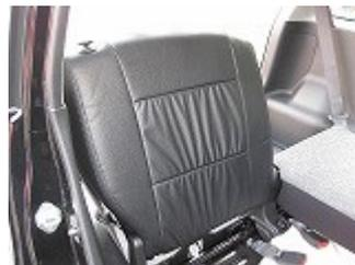
3 背もたれ下部の生地を巻き込みマジックテープで固定し、1で外したノブをカバーの穴を通し元に戻します。
