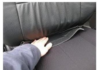
4 座面と背もたれの間からカバーを入れ込み後ろから引き出します。
