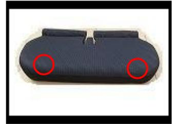
4 座面を車外に出します。赤丸の位置の下にピンで固定されています。
