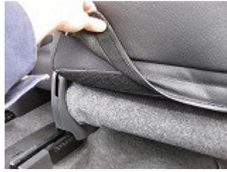
6 座面と背もたれの間から引き出したマジックテープを固定します。
