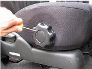
1 シートリフター中心部のカバーを精密ドライバー等を使用し外します。
