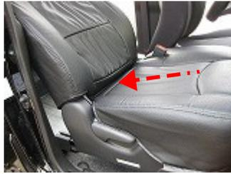
2 座面と背もたれの間からカバーを入れ込み後ろから引き出します。
