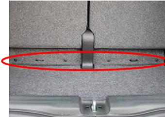
1 始めに荷室側へ回り、座面後ろの赤丸部のピンを取外します。(4箇所)
