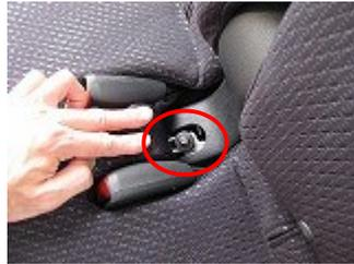
2 シートベルトバックル部間のシートをめくりボルトを外します(ボルト径10mm)
