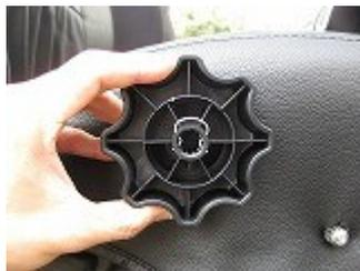
6 ピンと本体を組み付け元に戻します。
