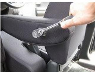
1 アームレストを取外します。側面のキャップを取外し中のボルトを取外します(ナット径13mm)
