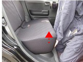
3 座面の手前側を持ち上に引き上げます。
