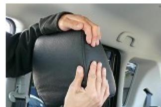
3 カバーと本体のラインを合わせ背もたれより取外し所定の方法で固定します。
