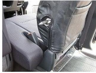
7 アームレストの軸はカバーの切れ込み部に合わせ逃します。
