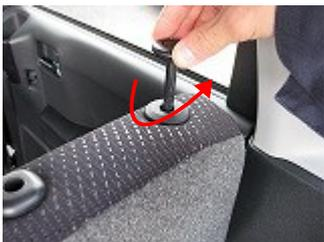
1 始めにリクライニングのノブを矢印の方向に回し取外します。
