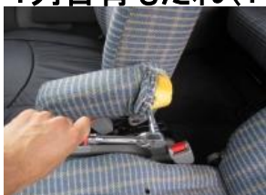
1、アームレストを取り外します。純正生地をめくり、ソケットレンチを使用し、中のネジを外します。(ナットサイズ17mm) ※アームレスト有車のための作業です。
