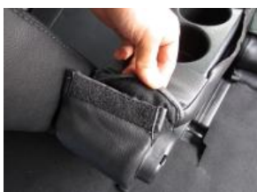
5、4で引き出したカバーをマジックテープで固定します。
