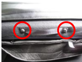
6、シート背面の赤丸部のカバーを先の細いマイナスドライバー等で外します。
