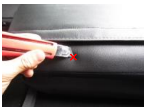
9、6で外したベルトを取り付ける穴を、カッター等で切れ込みを入れます。
