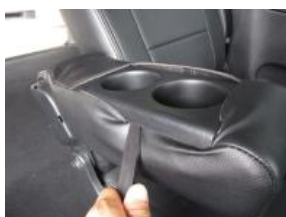
6、付属のヘラを使用してドリンクホルダー周辺のカバーをプラスチック部に入れ込みます。
