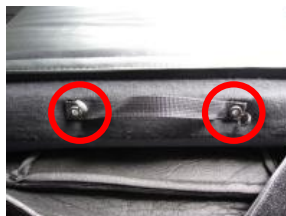
7、中のネジを緩めベルトを取り外します。
