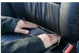
5 背もたれと座面の隙間にカバーを入れ込みます。
