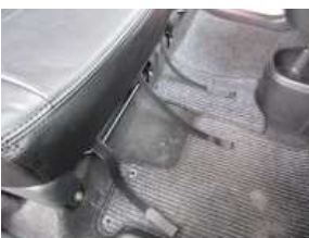
15、14で後ろに回したバンドを赤丸部を通して後ろに回します。 ※シート下を通す際は、シートの可動の妨げにならない箇所を通して下さい。
