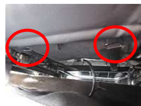
16、14で後ろに回したバンドを赤丸部の金具を通してマジックテープで固定します。
