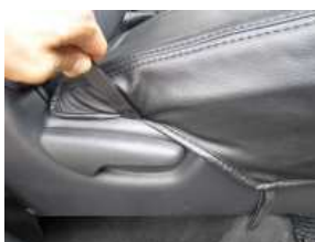
6、付属のヘラを使用して、側面のプラスチック部分へカバーを入れ込みます。
