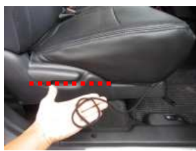
11、シート側面の紐を、プラスチックカバー内部を通して後ろへ回します。
