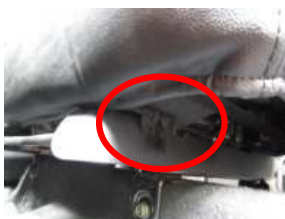
14、内側の紐はシート前方赤丸部のの輪っかを通して固定します。
