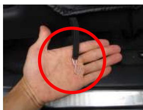
7、カバー側面のバンドの先に、付属のSフックを取り付けます。
