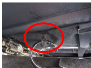
13、後ろへ引き出した紐を4で引き出したカバー先端の輪っかを通して固定します。
