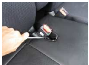
17、付属のヘラを使用して、シートベルトのバックル部分にカバーを入れ込みます。
