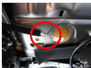
9、入れ込んだSフックは、シート下の金属部に引っ掛け固定します。
