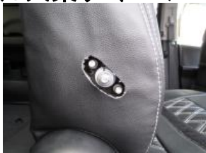
6、外側にアームレストが装備されている場合は、1列目と同様にカバーに穴を開け加工を施します。
