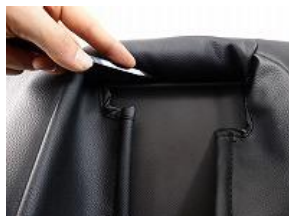
7、アームレストを収納する内側の生地をヘラを使い差し込みます。
