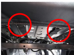
9、後ろへ回したバンドは赤丸のリングを通し固定します。
