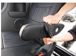
1、アームレストが柔らかく、被せにくい為、一度背もたれにアームレストを取り付け、カバーを被せます。
