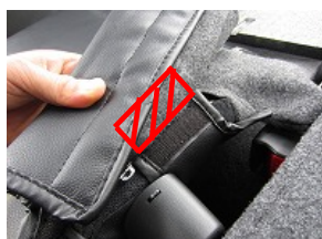
15、内側の前から引き出したカバーは赤斜線部に固定します。
