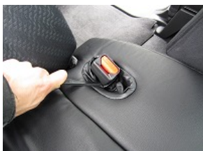
10、シートベルトバックル部のカバーを折り返し入れ込みます。
