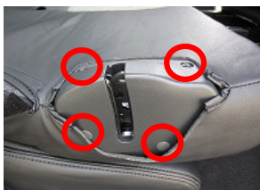
9、背もたれのロック部も同様に赤丸部のネジ・ピンを緩めブラカバーを浮かせて、シートとブラカバーの隙間に入れ込んで下さい。
