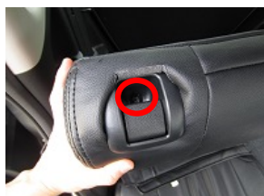
7、リクライニングレバー周りは、赤丸部のネジを緩め、ブラカバーを浮かせてシートとブラカバーの隙間に入れ込んで下さい。
