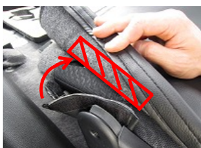
13、前から引き出したカバーのマジックテープは赤斜線部に固定します。
