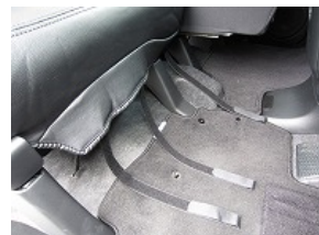
8、カバー前方のバンドをシート下を通し後ろへ回します。 ※シート下を通す際は、シートの可動の妨げにならないように気をつけます。
