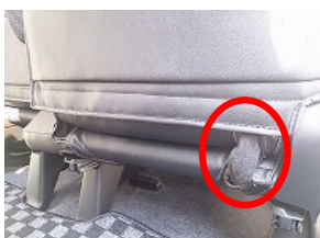
サイドエアバッグ付き車は、カバーの切れ込み(丸部)から配線を逃し、取り付けを行ってください。
