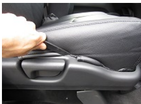
5、側面のカバーを付属のヘラ等を使用しプラスチックの中に入れ込みます。
