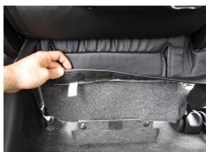
6、座面を跳ね上げ、5で入れたんだカバーのマジックテープをシートに直接固定します。
