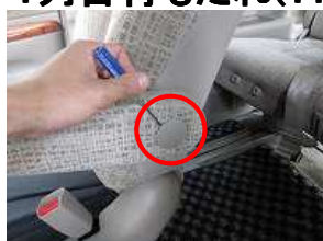
1、アームレストを取り外します。側面のカバーをマイナスドライバー等で外します。 ※アームレストのない車はこの作業はありません。
