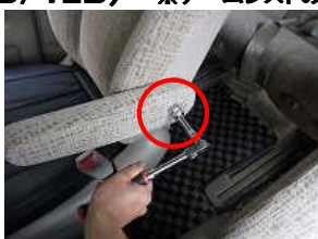
3、ボックスレンチを使用してボルトを外します。 (ボルトサイズ14mm)
