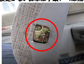
3、ボックスレンチを使用して赤丸部のボルトを外し、アームレストの軸を取り外します。 (ボルトサイズ10mm)
