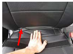
8、座面との隙間にカバーを入れ込みます。
