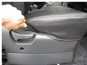
5、側面のカバーを付属のヘラを使用し、プラスチック部に入れ込みます。
