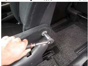
2、ボックスレンチを使用し、中のボルトを緩め、アームレストを取り外します。 (ボルトサイズ 17mm)
