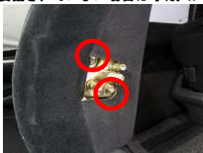
3、アームレストの台座のボルト(丸部)をボックスレンチを使用し緩め取り外します。 ※ボルトサイズ 10mm
