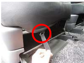
7、6のバンドをシート下を通し、前方の金属部で固定します。 ※シート下を通す際は可動の妨げにならない箇所を通して下さい。
