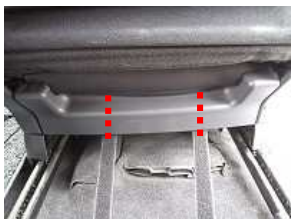
6、4で引き出したカバーのバンドをプラスチックカバーの内側に通します。
