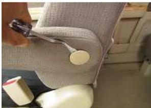
1、アームレスト側面のカバーを取り外します。
