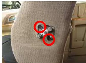
3、台座のボルトをソケットレンチで緩め、台座を取り外します。
