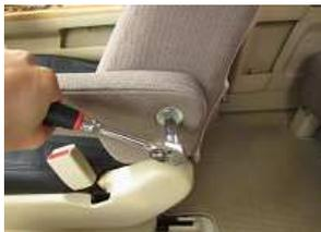
2、中のボルトをソケットレンチで緩めアームレストを取り外します。
