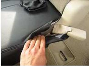
9、内側のシートベルト部のカバーを折り返し入れ込み、マジックテープを直接シートに貼り付けます。
