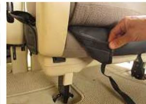
4、3で引き出したカバーのマジックテープを直接シートに貼り付けます。
