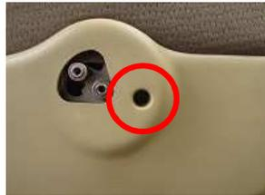
3、丸部のネジをプラスドライバーで緩め取り外します。
