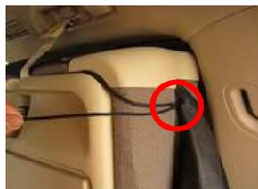
7、内側面の紐を後ろに回し、赤丸部の輪の中を通します。
