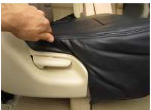
5、ヘラを使用し側面のプラスチック部の中にカバーを入れ込みます。
