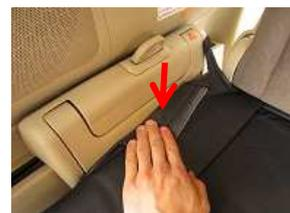
4、外側面のカバーをプラスチック部の隙間に入れ込みます。
