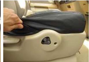
8、付属のヘラを使用し、プラスチック部にカバーを入れ込み、1-3で外したレバーを元に戻します。
