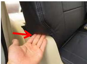
5、後ろに回した後、プラスチック部の奥にカバーを入れ込みます。
