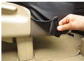
6、カバー側面のマジックテープも直接シートに貼り付けます。
