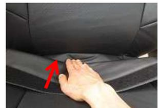
8、座面との隙間にカバーを入れ込みます。
