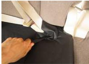
10、シートを戻し、シートベルトバックル部のカバーを折り返し入れ込みます。ベルトとバックルを固定し引っ張りだすと、取り出しやすくなります。
