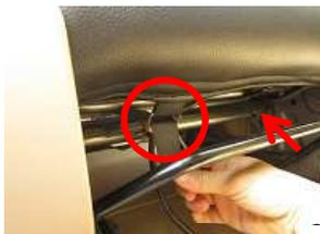
10、ベルトを前に回す際は、矢印のバーの上を通し、赤丸部の金具を通し固定します。
