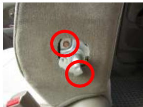
3、赤丸部のボルトを外し、アームレスト取付部の台座を取り外します。 (ボルトサイズ 10mm)
