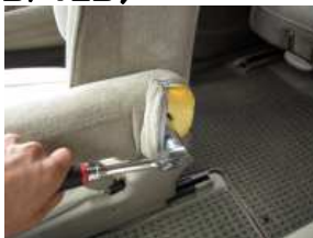
2、ボックスレンチを使用し、中のボルトを緩め、アームレストを取り外します。 (ボルトサイズ 14mm)
