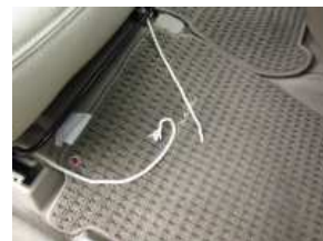
8、カバー前方の紐をシート下を通して後ろに回し固定します。 ※シート下を通す際は、シートの可動の妨げにならない箇所を通して下さい。
