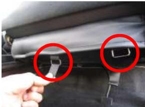
9、8で後ろに回したバンドを赤丸部の金具を通してマジックテープで固定します。
