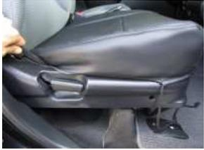
5、付属のヘラを使用して、側面のプラスチック部分へカバーと紐を入れ込みます。
