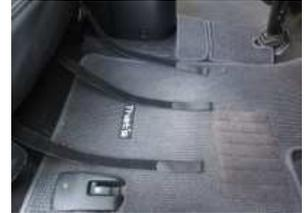
8、カバー前方のバンドをシート下を通して後ろに回し固定します。
