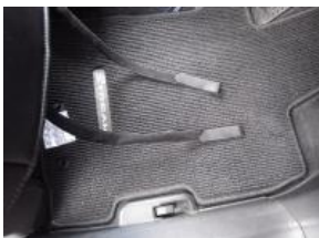
13、カバー前方のバンドをシート下を通して後ろに回し固定します。 ※シート下を通す際は、シートの可動の妨げにならない箇所を通して下さい。
