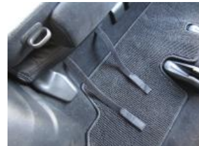
11、カバー前方のバンドをシート下を通して後ろに回し固定します。 ※シート下を通す際は、シートの可動の妨げにならない箇所を通して下さい。
