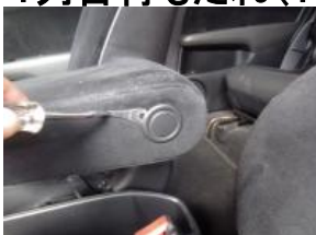
1、はじめにアームレストを取り外します。側面のカバーを内張りをはがして外します。 ※1-3はアームレストの有る車だけの作業です。
