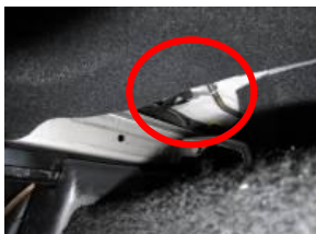
7、入れ込んだバンドのフックはシート下の金属部に引っ掛け固定します。
