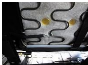
11、後ろへ回したバンドのフックをシート下の金属部に引っ掛け固定します。 ※画像はわかりやすいように、シートを取り外して説明しています。
