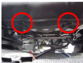
14、13で後ろに回したバンドを赤丸部の金具を通してマジックテープで固定します。 ※引っ張り過ぎるとちぎれる恐れがあるので注意して下さい。
