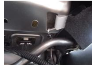
8、6で取り付けたS字フックをシート下の金属部に引っ掛け固定します。
