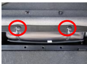
6、5で引き出したカバー先端のバンドにS字フックを取り付け、丸部に引っ掛け固定します。
