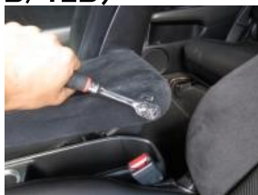
2、ボックスレンチを使用してボルトを外します。 (ボルトサイズ17mm)
