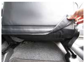
6、シート背面のマジックテープを固定します。
