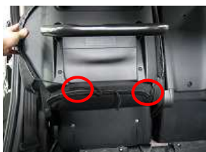
6、左右から回したヒモを輪の中を通し固定します。
