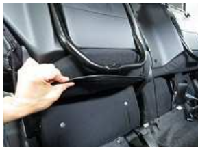
3、2で入れ込んだカバーを引き出しシートに直接固定します。
