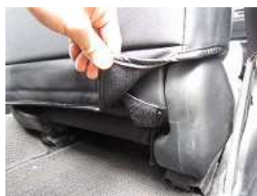
7、6で引き出したカバーのマジックテープを固定します。
