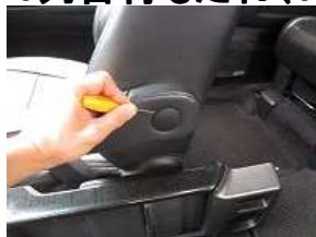
1、アームレスト側面のカバーを先の細いマイナスドライバー等で外します。
