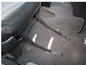
6、カバー前方のバンドをシート下を通して後ろに回し固定します。 ※シート下を通す際は、シートの可動の妨げにならない箇所を通して下さい。
