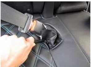
9、シートベルトバックル部のカバーを折り返し入れ込みます。ベルトとバックルを固定し引っ張りだすと、取り出しやすくなります。
