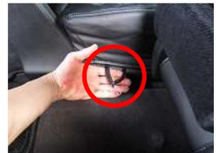
12、助手席側カバー(22A)の内側面にはゴムバンドがついています。付属のS字フックを取り付けます。
