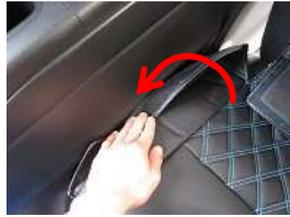
3、シートとカバーのラインを合わせながら側面のカバーをプラスチック部の隙間に入れ込みます。
