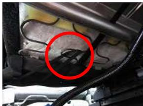
10、9で巻き込んだカバー先端のバンドをシート裏の金属部に引っ掛け固定します。
