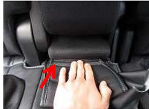
3、アームレスト下部の隙間にも同様にカバーを入れ込みます。
