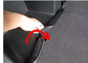
7、シートを床下に格納し、3で入れ込んだカバーを引き出し、マジックテープを直接シートに貼り付けます。
