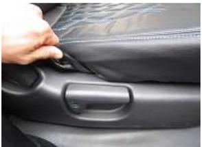
5、ヘラを使用し、側面のプラスチック部にカバーを入れ込みます。
