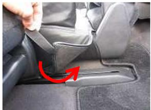
6、内側面のマジックテープは、シート裏側の純正生地 directly 貼り付けます。
