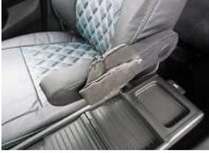
1、取り外した反対の手順でアームレストを取り付け、半分ほど裏返したカバーを前から被せます。
