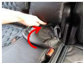
7、アームレスト下部のパーツにカバーを前から被せ、アームレストとの隙間にカバーを入れ込みます。
