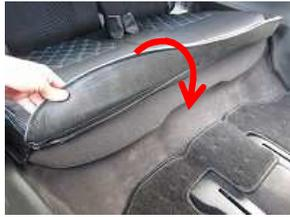
2、シート前方の純正生地にカバーを被せ、マジックテープをシートに直接貼り付け固定します。
