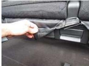
6、5で引き出したカバーのマジックテープを直接シートに貼り付けます。
