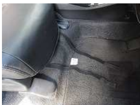
6、カバー前方のバンドをシート下を通し後ろへ回します。
