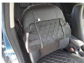
1、カバーを裏返し、純正シートの肩口にカバーをしっかりと被せます。
