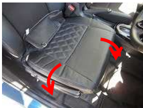
2、側面のカバーを表に戻し、カバーとシートのラインを合わせます。
