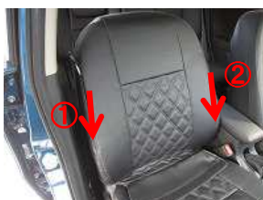
2、裏返したカバーを少しずつ表に戻しながら①・②の順で左右均等に下ろして下さい。
