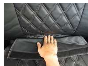
4、座面との隙間にカバーを入れ込みます。
