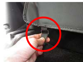
8、後ろへ引き出したバンドを赤丸部の金具を通しマジックテープを貼り合わせ固定します。 ※バンドはあくまで補助的な固定の役割となるので、極端に強く引っ張り過ぎないでください。
