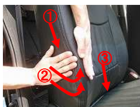
3、背もたれ側面のカバーを、画像の①～③の順番に純正シートの形状(ライン)に合うまで繰り返し均して下さい。 ※画像は他の車種です。
