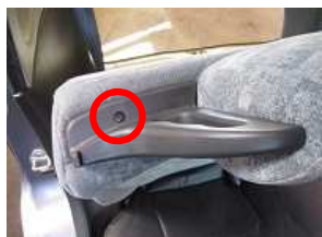
1、肩口外側の持ち手のネジをプラスドライバーで緩め外します。 ※画像はシートを少し倒し、持ち手を真上から見えています
