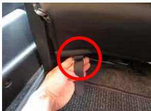
7、後ろに回したバンドを赤丸部の金具を通しマジックテープを貼り合わせます。 ※バンドはあくまで補助的な固定の役割となるので、極端に強く引っ張り過ぎないでください。
