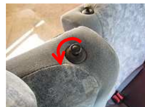
4、肩口内側のリクライニング用のノブを矢印の方向に回し取り外します。
