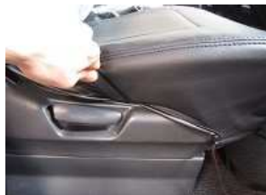
5、付属のヘラを使用し、側面のプラスチック部にカバーを入れ込みます。
