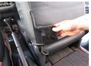
6、5で引き出したカバーのマジックテープと背もたれ裏側のマジックテープを貼り付け固定します。
