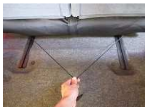
9、側面の紐を後ろに回し、結び固定します。固定方法は5ページの「紐の結びかた」を参照して下さい。
