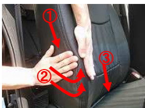
3、背もたれ側面のカバーを、画像の①～③の順番にシートの形状(ライン)に合うまで繰り返し均して下さい。 ※画像は他の車種です。
