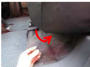
6、カバー前方のオスのマジックテープは、シート下の布部に直接貼り付け固定します。
