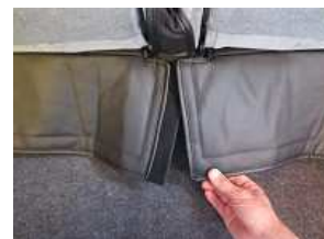
4、3で引き出したカバーのマジックテープを貼り合わせ固定します。
