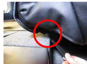
8、後ろに回したバンドを赤丸部の金具を通しマジックテープを貼り合わせます。 ※バンドはあくまで補助的な固定の役割となるので、極端に強く引っ張り過ぎないでください。
