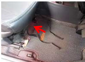
6、カバー前方のバンドはシート下を通し後ろに回します。 ※シートの可動の妨げにならない箇所を通して下さい。
