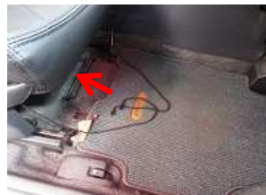
8、カバー前方の紐も同様にシート下を通し後ろに回します。 ※シートの可動の妨げにならない箇所を通して下さい。
