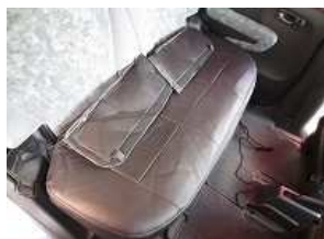
1、カバーを前から被せ、純正シートとカバーのラインを合わせます。
