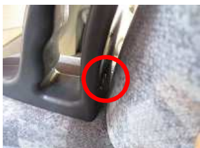
2、ヘッドレストを押さえつけ、内側のネジも緩め持ち手を取り外します。
