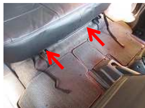
7、カバー前方のバンドはシート下を通して後ろに回します。 ※シートの可動の妨げにならない箇所を通して下さい。
