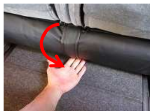
11、巻き込んだ生地の先端のマジックテープを、純正シート裏側の布部に直接貼り付け固定します。
