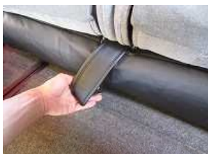
10、3で引き出した細長い生地をシートに巻き込みます。
