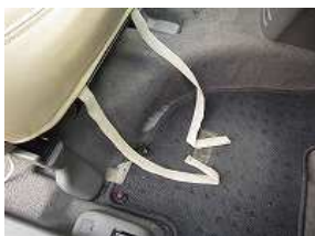
6、カバー前方のバンドをシート下を通して後ろに回し固定します。 ※シート下を通す際は、シートの可動の妨げにならない箇所を通して下さい。
