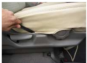
5、付属のヘラを使用して、側面のプラスチック部分へカバーを入れ込みます。
