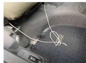
7、カバー前方の紐をシート下を通して後ろに回し固定します。 ※シート下を通す際は、シートの可動の妨げにならない箇所を通して下さい。
