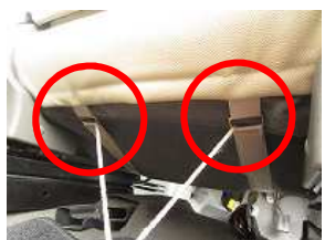
9、8で後ろに回した紐を、赤丸部の金具を通して固定します。
