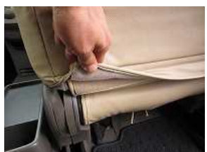
5、4で引き出したカバーのマジックテープを背面部と固定します。
