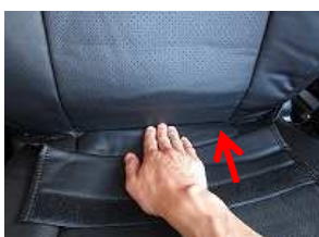
6、座面との隙間にカバーを入れ込みます。
