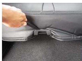
3、シート前方のプラスチック部の内側にカバーを入れ込みます。
