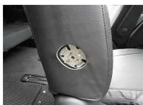
1、カバーの穴とアームレストの台座の位置を正確に合わせます。
