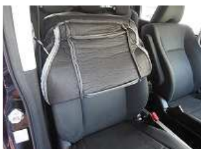
3、カバーを裏返し、純正シートの肩口にカバーをしっかりと被せます。
