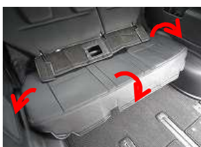
2、側面のカバーを表に戻します。
