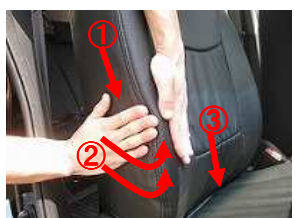
5、背もたれ側面のカバーを、画像の①～③の順番にシートの形状(ライン)に合うまで繰り返し均して下さい。 ※画像は他の車種です。
