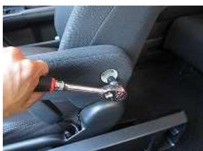
2、ソケットレンチを使用し、アームレストを取り外します。 (※ボルトサイズ14mm)
