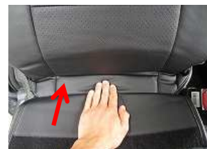
4、座面との隙間にカバーを入れ込みます。
