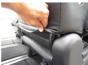
6、引き出したカバーのマジックテープと、背面のマジックテープを貼りあわせ固定します。
