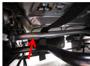
8、シート下を通す際は、矢印の金属のパイプの上を通して下さい。 ※シート下に手を入れる際は、シートの金属部で手を切らないように慎重に作業を行って下さい。
