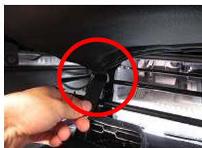
9、後ろへ引き出したバンドを赤丸部の金具を通しマジックテープを貼り合わせ固定します。 ※バンドはあくまで補助的な固定の役割となるので、極端に強く引っ張り過ぎないでください。
