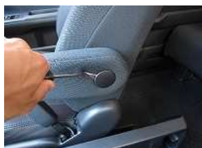
1、アームレスト側面のカバーを内張りはがし等で取り外します。
