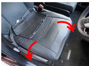
2、側面のカバーを表に戻します。
