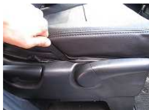
5、付属のフックを使用し、プラスチック部にカバーを入れ込みます。
