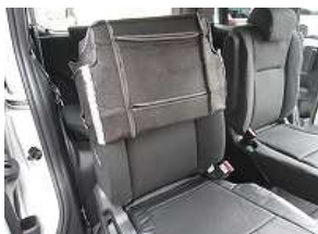
2、カバーを裏返し、純正シートの肩口にカバーをしっかりと被せます。
