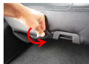
4、側面のカバーのマジックテープは直接シートに貼り付け固定します。
