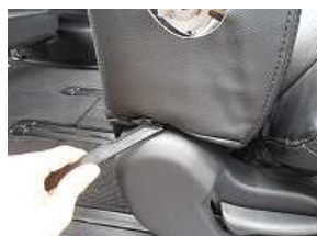
7、側面のカバーをヘラで内側に入れ込みます。
