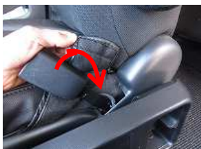
6、内側面のマジックテープはバックルの奥の純正生地直接貼りつけ固定します。
