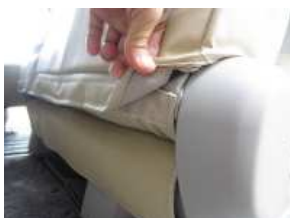
10、シート背面のマジックテープを固定します。
