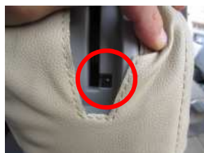
11、肩口のレバーのネジをプラスドライバーで緩めます。
