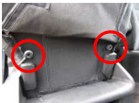
5、丸部のゴムをプラスドライバーを使用し、取り外します。
