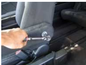
6、ソケットレンチを使用してアームレストを取り外します。 (ボルトサイズ14mm)
