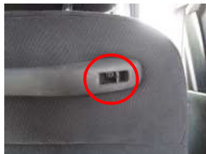
3、中のネジをプラスドライバーで緩め外します。
