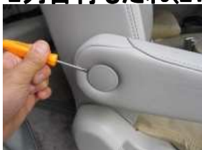
1、アームレストを外します。側面のカバーをマイナスドライバー等で外します。 ※アームレスト有り車のみの作業です。
