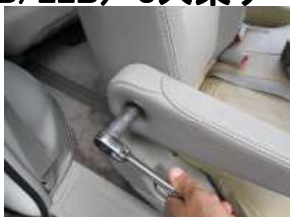
2、ソケットレンチを使用してアームレストを取り外します。 (ボルトサイズ17mm)
