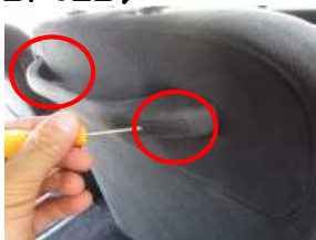
2、丸部のカバーをマイナスドライバー等で外します。
