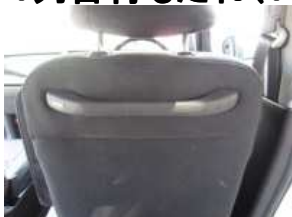
1、シート背面のアシストグリップを取り外します。 ※装備されていない車両もあります。
