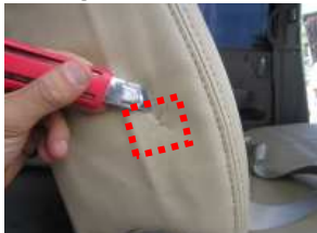
1、台座を通す位置にマジックで印をつけ、カッター等で切れ込みを入れます。
