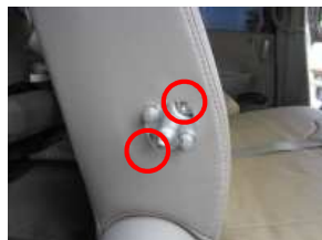
3、赤丸部のボルトをソケットレンチで外し、金具ごと取り外します。 (ボルトサイズ10mm)
