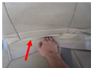
7、座面との間にカバーを入れ込みます。
