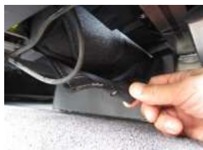
3、シートを跳ね上げ、2で入れ込んだカバーを下から取り出します。
