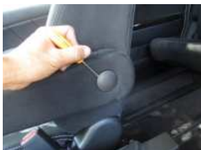
5、アームレストを外します。側面のカバーをマイナスドライバー等で外します。 ※装備されていない車両もあります。
