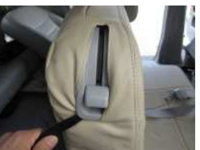
12、付属のヘラを使用してプラスチック部分にカバーを入れ込みます。
