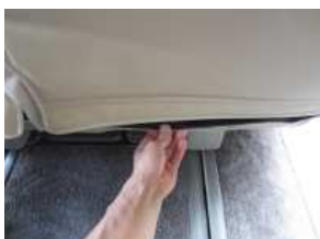
9、7・8で入れ込んだカバーを後ろから引き出します。
