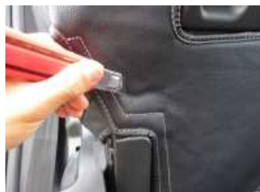
7、5で取り外したゴムを固定する切れ込みをカッター等で開けます。
