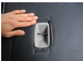
6、背もたれ背面のフックとカバーの穴位置を正確に合わせます。
