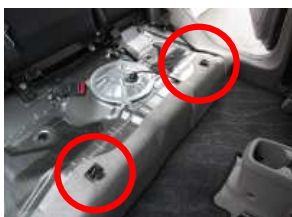
2、座面手前の丸部のピンのロックを解除します。 ※画像はわかりやすい様に座面を取り外して説明しています。
