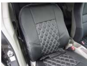
2、表に返しながらシートとカバーのラインを合わせ左右均等に下ろします。
