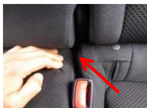
1、助手席側のシートベルトバックル収納部の奥(画像矢印部)のボルトをソケットレンチで緩め外します。(ボルトサイズ10mm)
