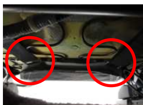
9、8で後ろに回したバンドを赤丸部の金具を通してマジックテープで固定します。 ※マジックテープは引っ張り過ぎるとちぎれますので注意して下さい。
