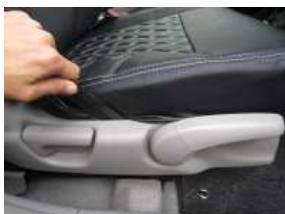
6、付属のヘラを使用して、側面のプラスチック部分へカバーを入れ込みます。
