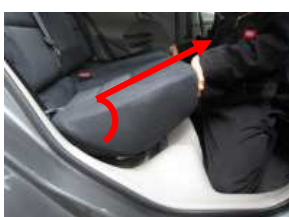
3、矢印の順に座面の手前を真上に持ち上げ、前方に引き抜き、座面を取り外します。
