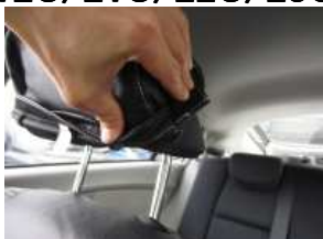
2、矢印の角にカバーを被せる際は、生地を破らないように、ヘッドレストを縮めながらカバーを被せて下さい。
