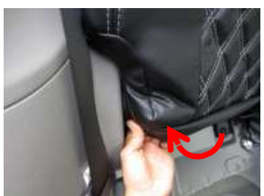
2、カバー下部の生地を矢印の方向に入れ込みます。シートの角部はしっかりとカバーを被せて下さい。
