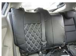
1、裏面のマジックテープを開き、センターのシートベルトを逃し横からカバーを被せ、カバー下部の生地を矢印の方向に入れ込みます。
