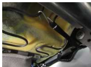
7、5で取り付けしたS字フックをシート下の金属部に引っ掛け固定します。
