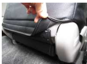
5、4で引き出したカバーのマジックテープと座面のマジックテープを固定します。
