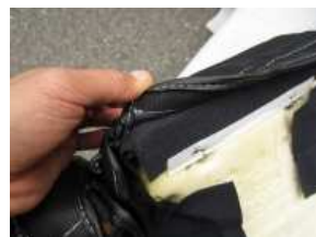
7、座面奥のマジックテープは直接シートに固定します。
