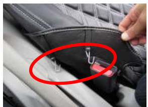
5、側面のカバーのバンドの先に、付属のS字フックを取り付けます。 ※左右ともに
