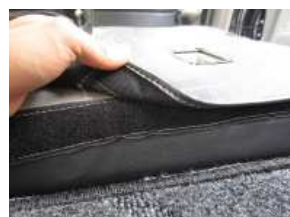
4、3で引き出したカバーをマジックテープで固定します。
