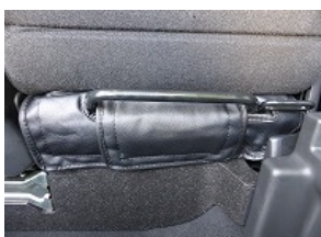
6、5で張り合わせたカバーをシート本体に直接張り付け固定します。
