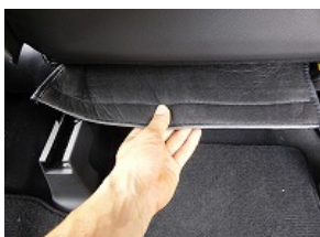
5、座面との隙間にカバーを入れ込み、後方から引き出します。
