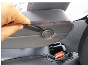
1、アームレスト側面のカバーを付属のヘラで取り外します。
