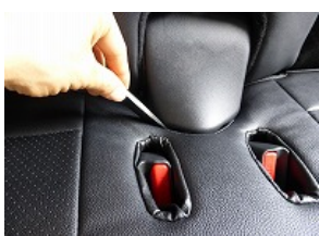
10、シート中央の生地もヘラを使い、プラスチック部の内側にカバーを入れ込みます。
