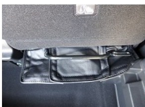
5、金属バーを避ける形でカバー同士のマジックテープを張り合わせ固定します。
