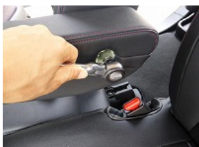
2、ソケットレンチを使用し、中のボルトを緩め、アームレストを取り外します。(ボルトサイズ 13mm)
