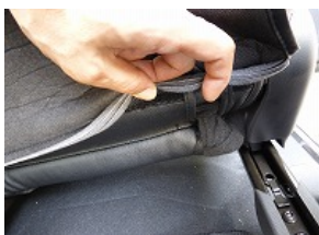
6、5で引き出したカバーのマジックテープを張り合わせ固定します。
