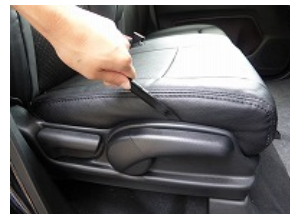
8、付属のヘラを使用し、プラスチック部の内側にカバーを入れ込みます。※096は若干形状が異なりますが取り付け方法は同じです。
