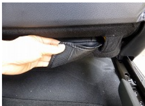
5、4で引き出したカバーのマジックテープをシート本体に直接張り付け固定します。
