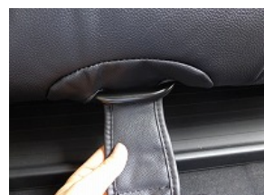
8、前方センター部分の生地はスライドレバーの内側を通し、シート裏側に直接張り付け固定します。
