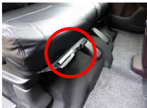
6、シート前方の赤丸のブラフックをシート裏側に引っ掛け固定します。
