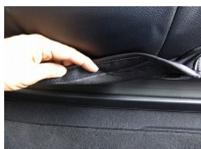
7、前方のマジックテープをシート裏側に直接張り付け固定します。
