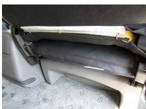
10、9で引き出した生地をマジックテープで固定します。
