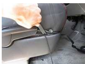
13、ヘラを使用してプラスチックの部分に生地を入れ込みます。
