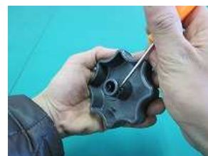
4、わかりやすいように外した状態で説明しています。先の細い工具等を使用して、ピンを取り外します。
