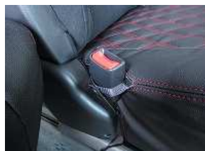
19、カバーの穴よりバンドを取り出し固定します。
