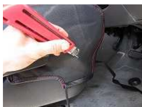
11、シートリフター取付部にカッターやはさみで切れ込みを入れ軸の部分を取り出します。
