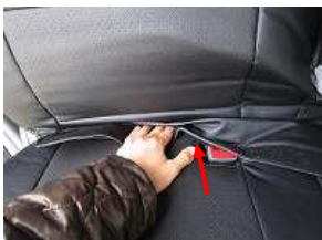
5、背もたれと座面の隙間からカ バーを入れ込みます。
