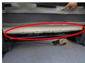
15、13で取り付けしたS字フックを固定します。カバーを奥に入れ込み純正の金属のバーに引っ掛けます。
