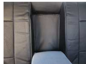
12、11で入れ込んだカバーをアームレスト収納部より引き出し、長方形のパーツをマジックテープで固定します。
