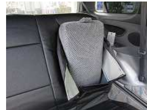
4、アームレスト部をカバーの穴より よけて取り付けます。
