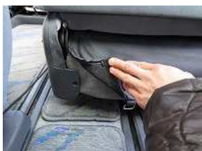
10、カバーのマジックテープを直接シートに固定します。
