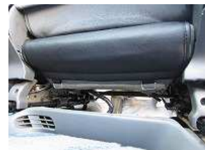
8、7で引き出したカバーをマジックテープで固定します。
