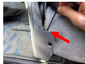
8、内側も同じようにシート下を通し、矢印の箇所から取り出します。
