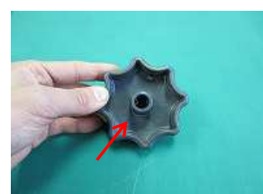
16、取り外したピンを、ダイヤルに取り付けます。
