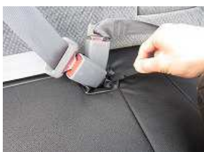
14、シートベルトバックル部の折り返しをシートの中に入れ込みます。
