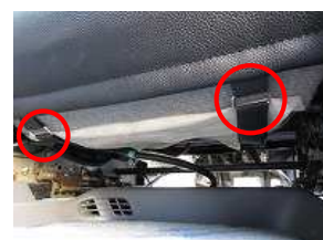
12、後ろへ回したバンドを赤丸部を通しマジックテープで固定します。
