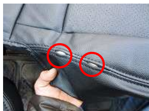
19、カバーの赤丸の切れ込みからバンドを取り出し、再度使用します。
