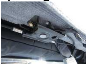
6、ピンを外したのち、純正の生地を少しめくり、画像の純正のパーツのネジを外します。 (ボックスサイズ10mm)
