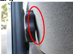
2、ダイヤルの側面より軸の部分についているピン(Cリング式)を確認します。
