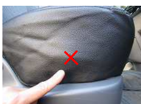
14、シートリフター取付部にマジックテープで印を付けます。
