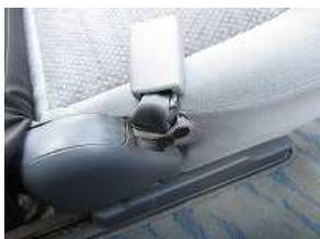
17、助手席側は、はじめにシートベルトのバックルを固定しているバンドを外しておきます。
