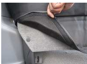
17、S字フックを全て引っ掛けた後、取り外した逆の手順で純正生地を戻します。最後にカバーのマジックテープを直接シートに固定します。
