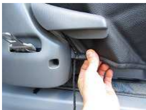
5、側面の紐も同じようにプラスチック部の中に入れ込みながら後ろへ回します。
