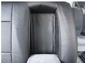
10、長方形のパーツをマジックテー プで固定し完成です。
