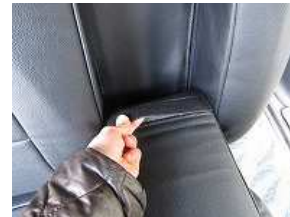
4、3で入れ込んだカバーを収納部 側より引き出し、マジックテープ で固定します。
