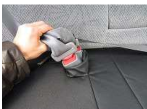
13、シートベルトのバックルを引き出します。ベルトとバックルを固定し引っ張りますと、取り出しやすくなります。
