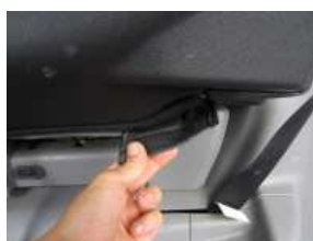
7、座席を跳ね上げ、6で入れ込んだカバーをマジックテープで直接シートに固定します。
