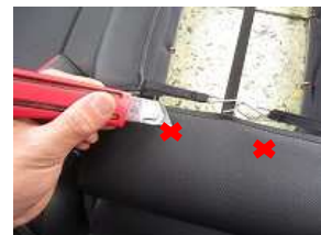
8、2で外したネジを通す切れ込みをカッターで入れます。
