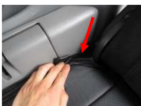
6、外側のカバーは矢印の箇所より入れ込みます。
