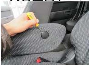
1、はじめにアームレストを取り外します。側面のカバーをマイナスドライバー等で外します。
