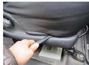
12、側面のカバーをプラスチックカバーの隙間に入れ込みます。
