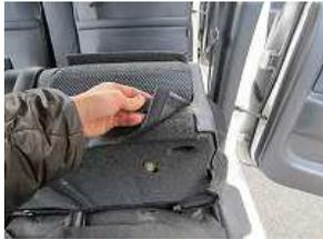
6、引き出したカバーのマジックテープを直接シートに固定します。
