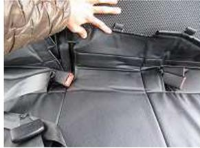
3、シートベルトのバックルをカバーの穴から取り出します。
