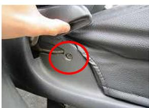
11、リクライニングレバー周辺は、内側のネジを外しカバーを入れ込み、再度ネジを取り付けます。
