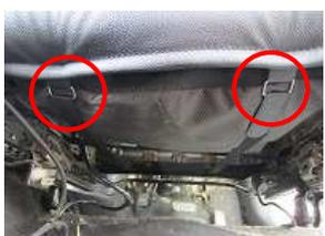
12、シート下のゴムバンドと紐を、可動部の妨げにならないように固定します。
