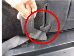
7、シートベルトのバックルをバンドより外します。
