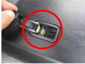
2、中にあるボルトを緩め取り外します。ボルトサイズ10mm
