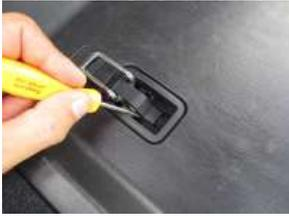
1、はじめにバックテーブルを外します。フックを起し、中のツメを先の細いマイナスドライバーで起こします。
