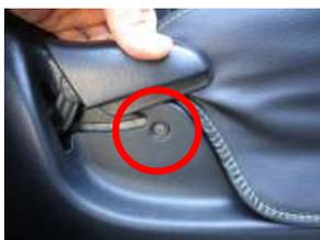
10、リクライニングレバーを上げ、中のネジをプラスドライバーで緩めます。
