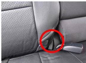
10、1で外したバンドをカバーの隙間から取り出し、バックルを固定します。
