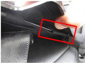
5、4で入れ込んだカバーを後ろから引き出し、カバー先端のフックを純正シートに引っ掛け固定します。
