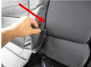
6、内側面のカバーをアームレストとの隙間に入れ込みます。
