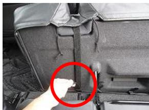
3、カバー後方のバンドを丸部の金具を通しシート下で固定します。
