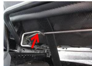
16、カバー前方のバンドはトレイのレールの上を通します。それ以外は運転席側を参考にし取り付けして下さい。
