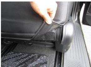
9、5で引き出したカバーのマジックテープと背面のマジックテープを貼り合わせ固定します。
