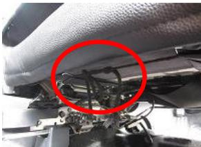
13、金具を通した紐を結び固定します。固定方法は4ページのワンポイントを参照して下さい。
