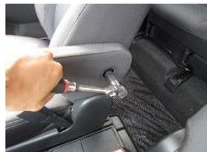
2、ボックスレンチを使用し、中のネジを外し、レバーを取り外します。(ボルトサイズ 14mm)
