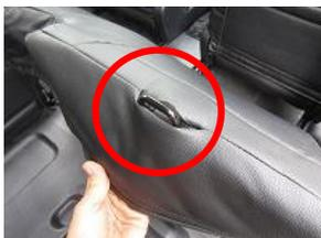
2、座面を跳ね上げて起こし、カバーの切れ込みからフックを取り出します。
