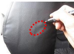
1、背もたれのカバーを正確に被せた後、アームレスト取付の穴位置にマジック等で印を入れます。
