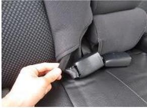
1、シートベルトのバックルを固定しているバンドを外します。
