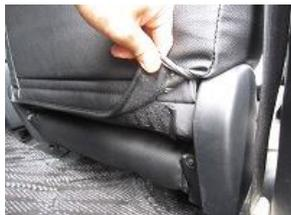
7、引き出したカバーのマジックテープと背面のマジックテープを貼り合わせ固定します。
