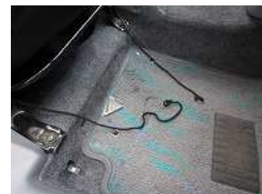
8、カバー前方の紐をシート下で固定します。 ※シートの可動の妨げにならない箇所を通して下さい。
