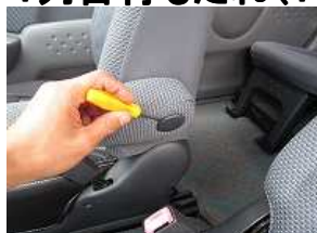
1、アームレストを取り外します。 カバーを内張りはがし等で外します。 ※アームレスト有り車のみの作業です。
