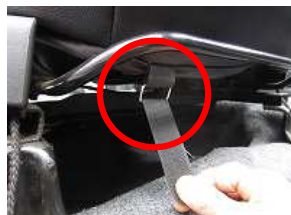
7、6で前に回したバンドを赤丸部の金具を通してマジックテープで固定します。
