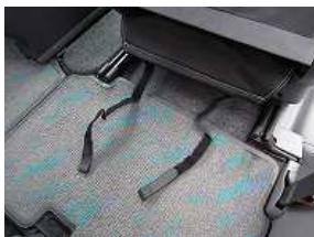
6、カバー後方のバンドをシート下を通して前に回し固定します。 ※シート下を通す際は、シートの可動の妨げにならない箇所を通して下さい。
