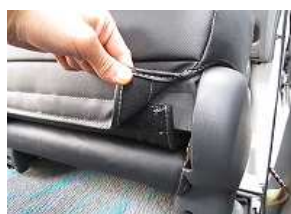
7、6で引き出したカバーのマジックテープと座面のマジックテープを固定します。
