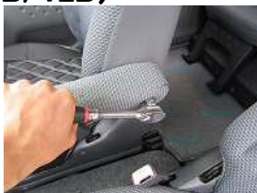
2、ボックスレンチを使用し、中のボルトを緩め、アームレストを取り外します。 (ボルトサイズ 14mm)
