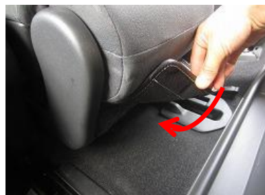
15 10で引き出したカバーのマジックテープをシートに直接貼り付け固定します。
