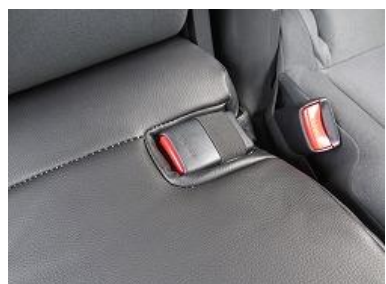
21 1で外したバックルを、カバーに付いているバンドで固定します。
