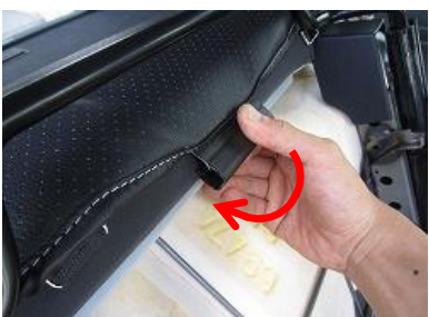
17 画像のようにフックを折り返し、純正シートのフチにフックの開口部を挟み込みます。画像は説明しやすいようにシートを外していますが、実際の作業時はシートを外す必要はありません。
