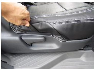
11 ヘラを使用し、プラスチック部の中にカバーを入れ込みます。
