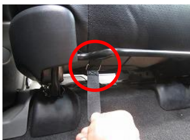
20 前へ引き出したバンドを赤丸部の金具を通しマジックテープを貼り合わせ固定します。 ※バンドはあくまで補助的な固定の役割となるので、極端に強く引っ張り過ぎないでください。
