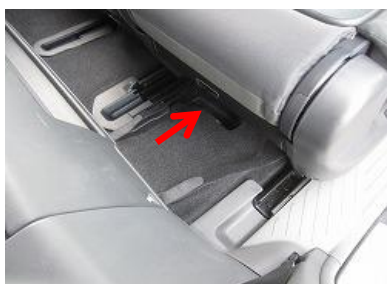
19 5で後ろに引き出したバンドをシート下を通し前に回します。 ※シート下に手を入れる際は、シートの金属部で手を切らないように慎重に作業を行って下さい。
