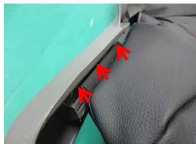
12 外側面(ドア側)のカバーにはブラフックがついています。ブラフックをシートのプラスチック部に引っ掛けるように入れ込み、カバーが出てこないように調整して下さい。画像はシートのプラスチックカバーを取り外し内側から見た画像です。
