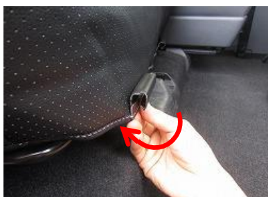
16 カバー側面のJ型のブラフックは、内側に折り返しシートに直接引っ掛け固定します。
