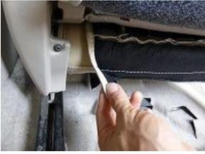
5、4で引き出したカバーを座面カバーのマジックテープと張り合わせ固定します。
