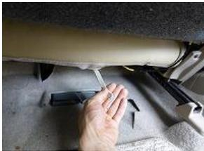
9、6で引き出したカバーの中央に付いているゴムにS字フックを取り付け、シート裏に引っ掛けて固定します。
