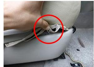
12、S字フックをシートとプラスチックカバーの隙間を通して、シート裏に出します。
