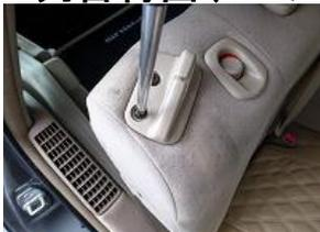
1、シートベルトの引っ掛けをプラスチックドライバーを使い取り外します。
