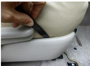
13、側面のカバーをシートとプラスチックカバーの隙間にヘラを使い入れ込みます。
