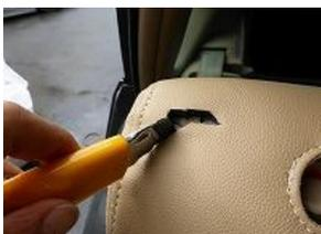
9、1で取り外した箇所のネジ穴位置にカッターで切れ込みを入れ、取り外した時と逆の手順で取り付けます。
