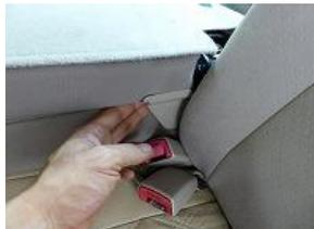
3、側面のアームレスト横のプラスチックカバーを取り外します。
