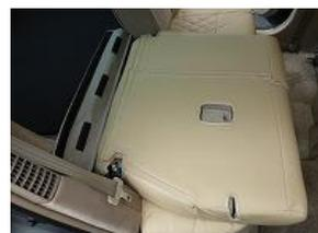
8、側面の生地も後方へ回し、すべてのマジックテープを張り合わせて固定します。
