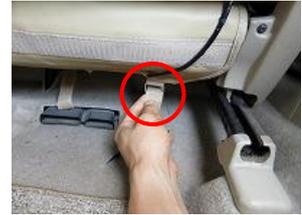
8、7で後方に回したバンドを赤丸のリングを通してマジックテープで固定します。
