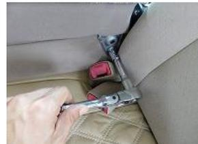
4、ボックスレンチ(12mm)を使いボルトを緩めアームレストを取り外します。
