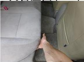
1、座面の手前側を持ち、上に引き上げ外します。
