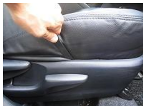
7、付属のヘラを使用し、外側面のプラスチック部の中にカバーを入れ込みます。
