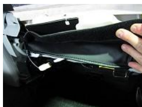
11、PHV(プラグインハイブリッド)に取り付けの際はシートヒーターの配線の上からカバーを巻き込ませ、取り付けして下さい。
