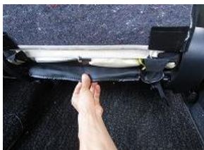
6、5で入れ込んだカバーを、サイドエアバッグの配線を通し後ろから引き出します。
