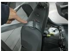
5、センターのシートベルトを固定しているボルトを外します。
