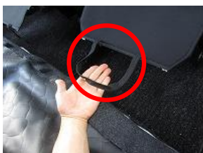
2、赤丸のゴムがシート下の金属部に引っ掛けて固定してあります。
