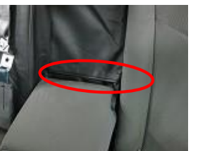
10、アームレストの下部のカバーを隙間から入れ込み後方より引き出します。
