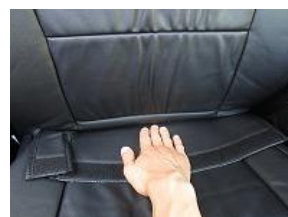
4、座面との隙間にカバーを入れ込み後ろから引き出します。
