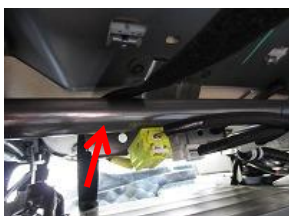
9、シート下にバンドを通す際は、矢印の金属のパイプの上を通して下さい。
