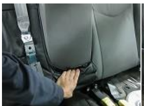
9、5で外したシートベルトを穴から取り出します。
