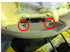
9、赤丸部のネジを緩めカバーを取り外します。
