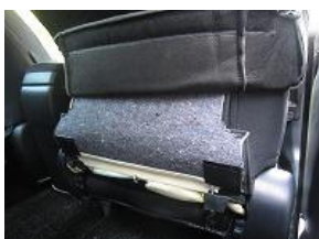
2、座面(1・2)で外した生地をカバーの中に入れ込みます。
