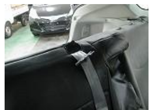
8、カバーを被せます。アームレスト部はカバーの間から出した後、全体のラインを整えて下さい。
