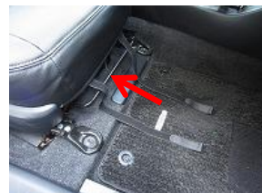
8、カバー前方のバンドをシート下を通し後ろへ回します。
