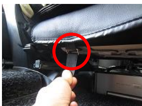
10、後ろへ引き出したバンドを赤丸部の金具を通し固定します。 ※バンドはあくまで補助的な固定の役割となるので、極端に強く引っ張り固定しないで下さい。
