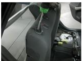
6、背もたれ肩口のシートベルトのガイドを外します。
