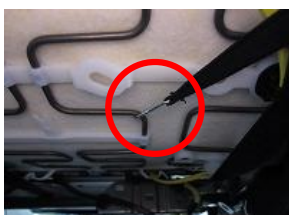
13、取り付けしたS字フックはシート下の金属部に引っ掛け固定します。
