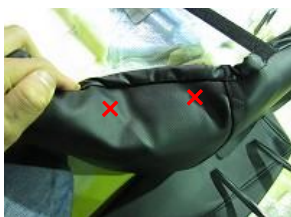
10、カバーを被せたのち、ネジの箇所にかッター等で切れ込みを入れます。
