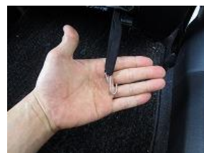
12、カバー先端のバンドに付属のS字フックを取り付けます。
