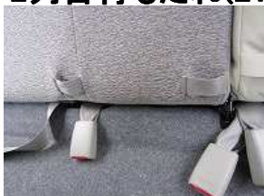
1、シートに固定されているシートベルト・バックルを外します。
