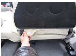
6、5で引き出したカバーをマジックテープで固定します。
