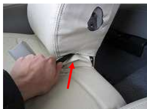
7、座面の矢印の箇所は背もたれカバーの内側に入れ込みます。
