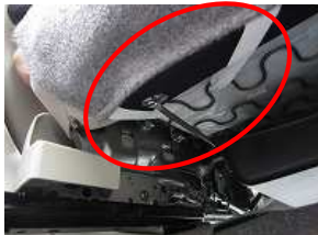
25、トレイのレール根元のネジを外しバンドを逃し、背もたれ裏側の純正生地を取り外します。
