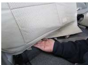
5、背もたれと座面の隙間にカバーを入れ込みます。
