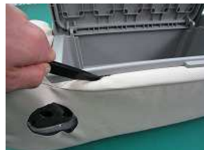
8、ヘラを使って、プラスチック部の中にカバーを入れ込みます。
