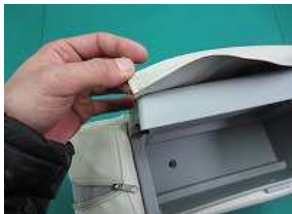
9、フタにカバーを被せます。始めに片方の角にカバーを被せ、生地伸びを利用しながら反対側の角にカバーを被せます。
