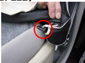
2、カバーを裏返し、背もたれを前に倒し、背もたれのロック部をカバーの穴より取り出しておきます。
