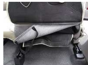
4、座面の取り付け時に外した純正生地を、めくり上げて背もたれカバーの中へ入れ込みます。
