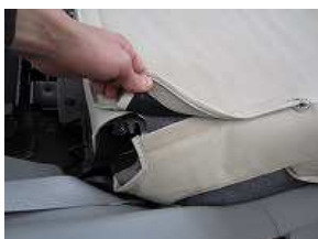
7、後ろから引き出したカバーをマジックテープで固定します。
