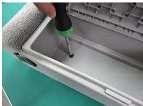
2、プラスドライバーを使用して小物入れの中にあるネジを取り外します。
