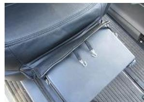
8、座面前方のカバーにS字フックを取り付け、折り返し入れ込みます。
