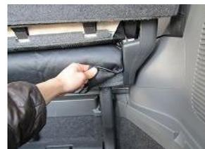
6、5で引き出したカバーのマジックテープをシートに固定します。
