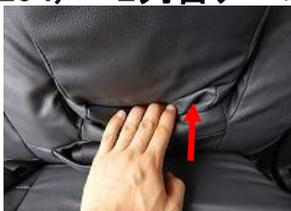
2、カバーを表に返し、背面との隙間にカバーを入れ込みます。
