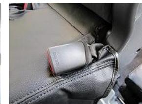
8、7で取り出したゴムを再度バックルに固定します。
