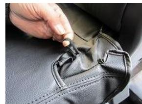
7、2で外したゴムをカバーの切れ込みより取り出します。
