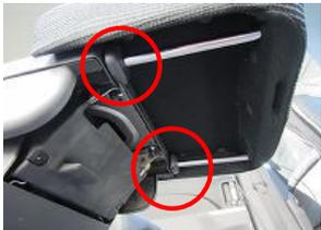
1、始めにオットマンを外します。赤丸の箇所のロックを押さえオットマンを取り外します。
