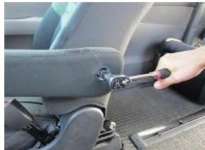
3、ソケットレンチを使用し、中のネジを外し、レバーを取り外します。(ボルトサイズ14mm)
