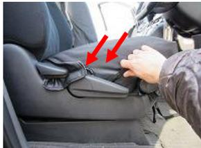
6、ヘラを使って、側面のプラスチック部の中に入れ込みます。
