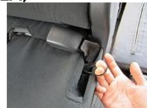
2、中央席のバックル部を固定しているゴムを外します。
