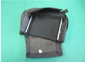
1、はじめに片面にカバーを被せ、生地伸びを利用して反対面にもカバーを被せます。
