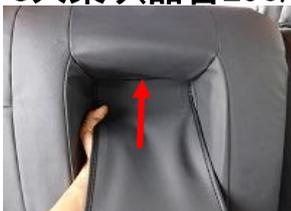
13、板状の別パーツを矢印方向に持ち上げながら入れ込み、マジックテープで固定します。
