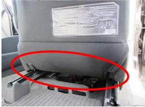
1、始めに背もたれ裏側の赤丸の箇所を外します。シート下にフックで固定されているので取り外します。
