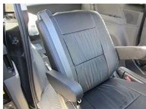
7、アームレスト部を1列目と同じように加工し、カバーを被せ完成です。(ボルトサイズ14mm)
