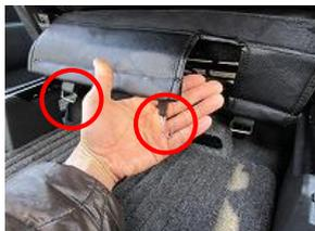
10、5で引き出したカバー先端のゴムバンドにS字フックを取り付け、シート下で固定します。
