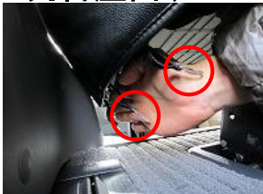
9、カバー側面のゴムバンドの先端にS字フックを取り付け
