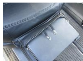
8、座面前方のカバーにS字フックを取り付け、折り返し入れ込みます。
