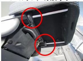
1、始めにオットマンを外します。赤丸の箇所のロックを押さえオットマンを取り外します。
