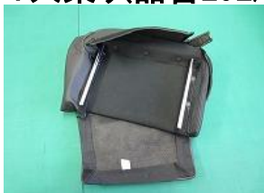
1、はじめに片面にカバーを被せ、生地の伸びを利用して反対面にもカバーを被せます。
