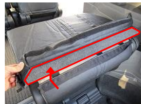
8、赤枠部の純正のボードを背もた れ裏側のカバーの袋状の中に入れ 込みます。
