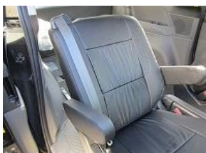
7、アームレスト部を1列目と同じように加工し、カバーを被せ完成です。 (ボルトサイズ14mm) 助手席側も同じように取り付けます。
