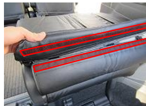
10、7で固定したカバーのマジック テープと背面側の生地をマジック テープで固定します。
