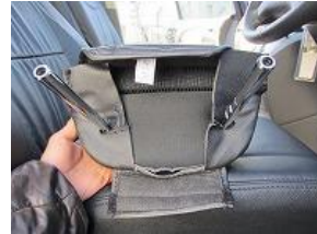
4、ヘッドレストのシャフトとカバーの 穴位置を合わせ、マジックテープで 固定します。
