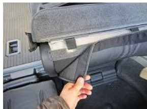
7、6で引き出したカバーをマジック テープで直接シートに固定します。
