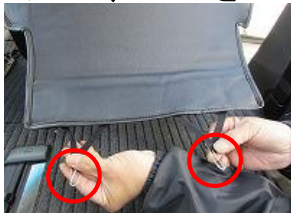
11、ゴムバンドの先端にS字フックを取り付け、シート下に固定します。
