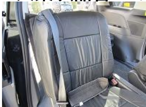
1、アームレストを1列目と同じように取り外し、背もたれにカバーを被せます。
