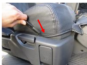
7、ヘラを使って、側面のプラスチック部の中に入れ込みます。
