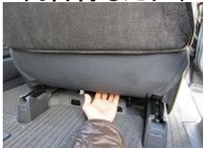
10、座面の取付時に取り外した純正シートのパーツを固定します。
