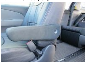
1、背もたれにカバーを取り付けた後、アームレスト本体をシートに取り付けます。
