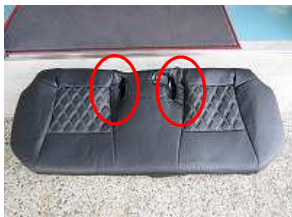
後席座面は赤丸のベルト周辺部が、カバーの構造上、浮いた状態になる場合があります。商品の不具合ではありませんので予めご了承下さい。
