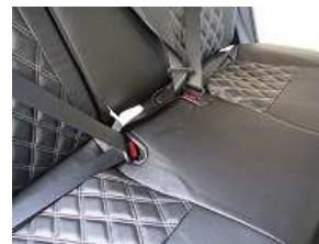
16、座面を車両に戻し、バックルを取り出す際は、画像の様にベルトを固定し引っ張りだすと取り出しやすくなります。
