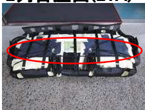
13、ゴムバンドは赤丸部を通し。結び固定します。
