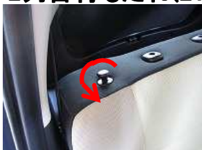
1、背もたれを倒すノブを反時計回りにまわし外します。
