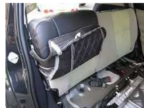
4、あらかじめ、カバーを裏返してから背もたれに被せます。左右均等に表に返しながら下ろします。
