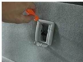
3、カバーを開け、中のツメを起こし外します。
