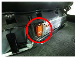
15、車両に取り付ける際は、赤丸部のバッテリーのスイッチを触らないように注意して下さい。
