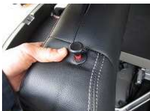
9、背もたれを倒すノブの土台を取り出し、ノブを取り付けます。
