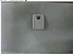
2、裏側のチャイルドシートフックのカバーを外します。
