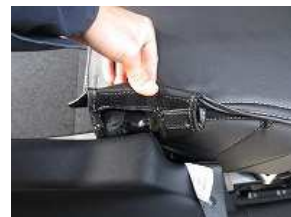
8、外側はカバー自体を折り返し、マジックテープで固定します。
