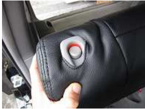
10、シートを倒すボタン周辺部はプラスチックの内側にカバーを入れ込みます。
