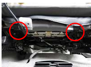
12、11で後ろに回したゴムバンドを、赤丸部の金具を通しマジックテープで固定します。 ※シートの可動の妨げにならないように注意して下さい。
