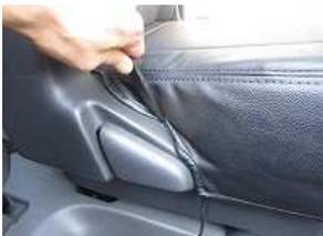
5、側面のプラスチック部に付属のヘラを使用しカバーを入れ込みませす。
