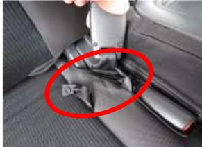
2、シートベルトのバックルを固定しているバンドをはずします。
