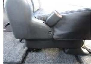
12、ヘラを使用しプラスチック部の中にカバーを入れ込んで、ネジを取り付けて下さい。
