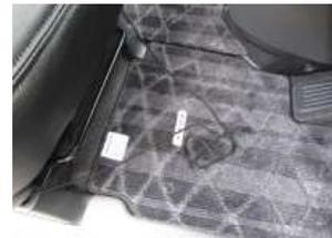
12、カバー前方の紐をシート下を通して後ろへ回します。
