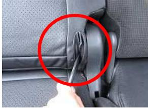
6、丸部のカバーをシートの切れ込みにヘラを使用し入れ込みます。
