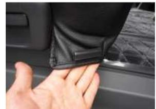
8、カバー側面のブラフックを固定します。
