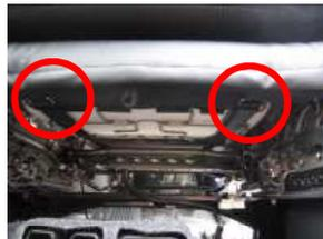
11、赤丸部の部分に9で後ろに回したバンドを通し、マジックテープで固定します。
