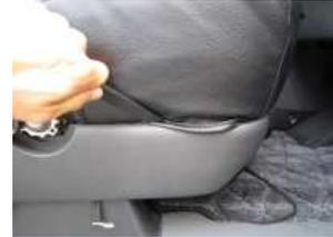
8、付属のヘラを使用して、側面のプラスチックの部分にカバーを入れ込みます。
