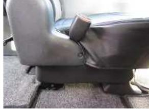
11、助手席側は内側面のプラスチック部のネジを緩めます。
