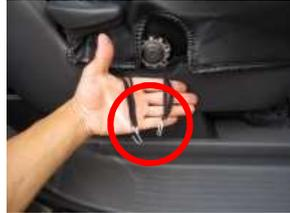
7、シート側面についているバンドの先に、付属のS字フックを取付けます。
