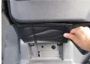
6、シートを跳ね上げカバーを直接マジックテープで固定します。
