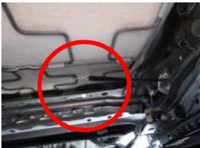
9、7で取付けたS字フックをシート下の金属部に引っ掛け固定します。
