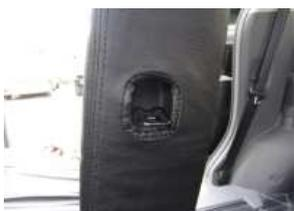
6、シート側面の金具の穴の位置を合わせます。
