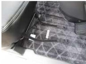
10、カバー前方のバンドをシート下を通して後ろに回し固定します。
