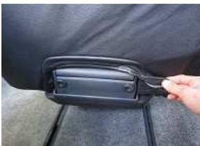
5、シートを格納し裏のカバーのマジックテープを直接シートに固定します。
