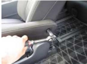
2、ソケットレンチを使用し、中のネジを外し、レバーを取り外します。(ボルトサイズ14mm)
