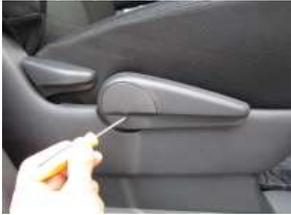
1、まず始めに、シートリフターを取り外します。カバーをマイナスドライバー等で外します。
