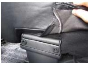
5、座面を跳ね上げ、カバーのマジックテープを直接シートに固定します。
