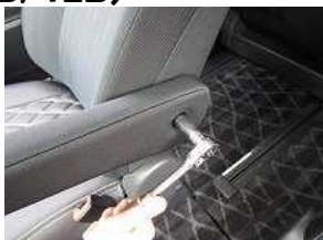
2、ボックスレンチを使用してボルトを外します。 (ボルトサイズ14mm)
