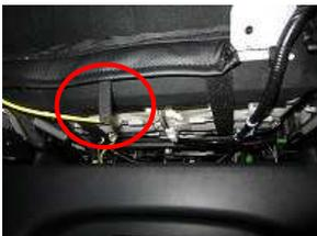
9、ゴムバンドにS字フックを取り付け、シートの金属部に引っ掛けます。
