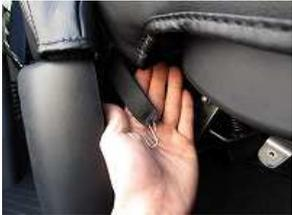
13、画像の丸部のバンドは先端にS字フックを取り付けシート下の金属部に引っ掛けます。
