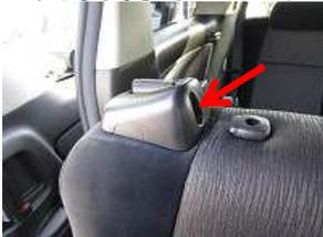
1、矢印の肩口のシートベルトのホルダーのネジと、丸部のカバーを外し、ネジを外します。
