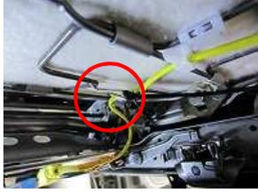
10、9で通したフックを図の金属部(赤丸)に固定します。
