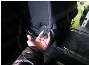
3、背もたれ側面の純正生地のカバーを外します。
