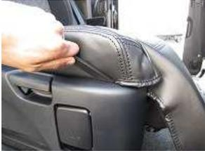
9、ヘラを使って、側面のプラスチック部の中に入れ込みます。
