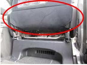
1、背面の赤丸の箇所を外します。座面下の隙間より手を入れ、フックを外して取り外します。
