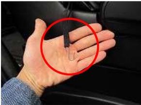
9、このようにS字フックを取り付けた後、プラスチックの隙間からシート下へ通します。
