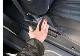
8、側面のゴムバンドにS字フックを取り付け、シート下へ入れ込み固定します。
