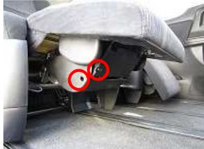
2、赤丸部(内側・外側の計4箇所)のプラスドライバーでネジを外し、カバーを取り外します。
