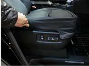
1、生地とシートのラインを合わせながら被せます。ヘラを使って、前面・側面のプラスチック部の中に入れ込みます。
