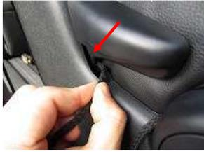
15、側面の紐はプラスチック部に入れ込み後ろへ回して下さい。
