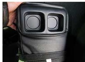
3、カップホルダーの後方に生地を入れ込みます。片側の角に生地をかけ、生地の伸びを利用し反対側にも被せます。
