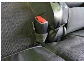
5、シートベルトバックルをホルダーから外します。
