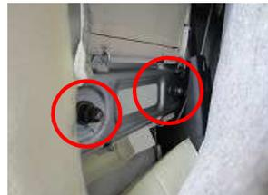
4、外した隙間から赤丸のアームレストを固定しているナットを外します。
