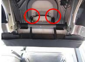
10、オットマン部前方のゴムバンドにS字フックを取り付け赤丸の箇所固定します。
