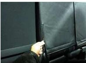
6、最後に背もたれ側面のチャックを締め完成です。
