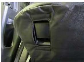
6、跳ね上げレバー部のマジックテープをシートに貼り付けます。
