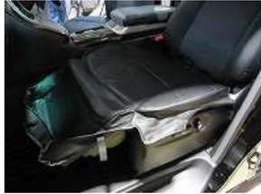
2、運転席と同じ様に背もたれの隙間に生地を入れ込みます。側面はヘラを使って、プラスチック部の中に生地を入れ込みます。
