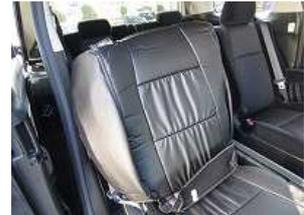
4、1列目と同じようにアームレストを取り外し、カバーとシートのラインを整えながら被せます。(ボルトサイズ14mm)
