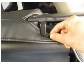
9、跳ね上げレバーの下にカバーを通します。
