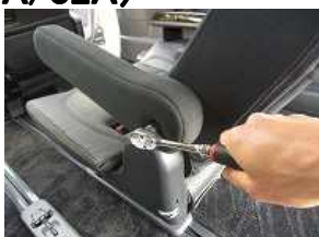
2、中のボルトをソケットレンチで外し、アームレストを取り外します。(ボルトサイズ 12mm)
