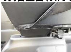
5、座面を跳ね上げ、シート裏側のマジックテープを固定します。
