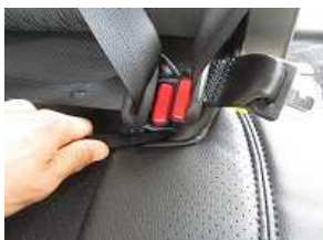
11、シートを元に戻し、シートベルトのバックル部のカバーを折り返し入れ込みます。画像の様にベルトを固定し引っ張りだすと入れ込みやすくなります。
