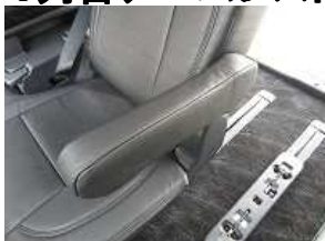
1、1列目アームレストの取り付け方法を参照し、カバーを被せます。
