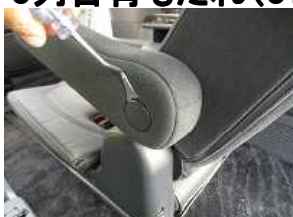
1、アームレスト側面のカバーを、内張りをはがし等で取り外します。
