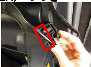
6、跳ね上げ固定用のバックルの片側のツメを、カバーの切れ込みに通します。
